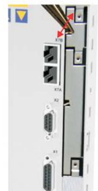
6 - Blech oben ausbrechen
